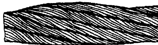
Рисунок 13. Местное увеличение диаметра каната
