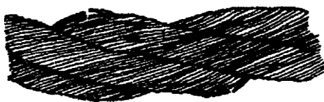
Рисунок 1. Обрывы и смещения проволок каната крестовой свивки
