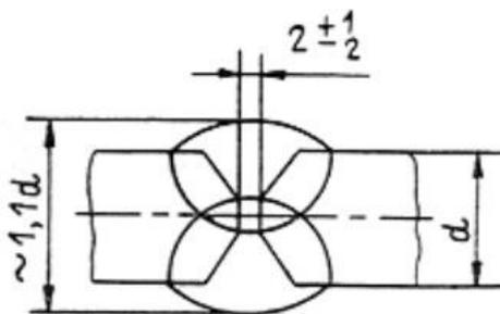
Рис. 3. Конструктивные элементы шва сварного соединения
