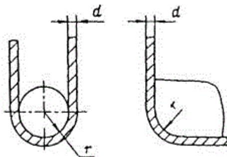
Рис. П.3.3. Обвязка грузов с закруглениями
