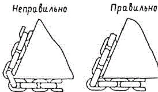
Рис. П.3.2. Строповка грузов цепными стропами
